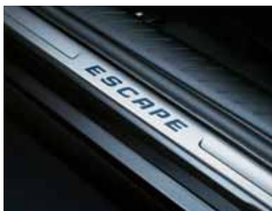
⑤スカッフプレート サイドシルを傷から守ると同時に、ドレスアップ効果も図れます。 (フロント/リア左右4枚セット) ※写真はフロント用です。リア用は形状が異なります。
