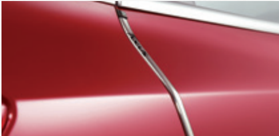
⑥ロゴ入りドアエッジガード FOCUSロゴがアクセントとなる樹脂製ドアエッジガードです。 1セットで4枚全てのドアに装着可能です。
