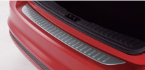
④リアバンパーロードプロテクター バンパー上部をキズ等から保護します。 アルミ調（樹脂製）でリアスタイルのアクセントにもなります。
